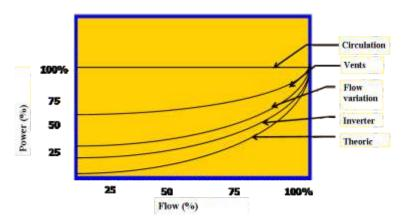
Figure 29. Calculation of fan capaciy
