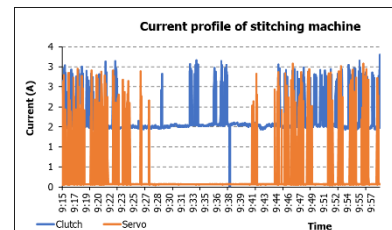
Kết quả đo đạc các động cơ đã lắp đặt
